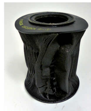
Рисунок 3: Деформация и разрушение картриджа масляного фильтра вследствие перегрева
