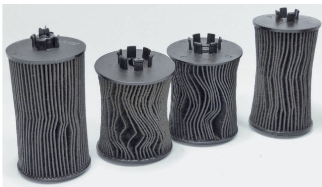
Zdjęcie 1. Zapadnięte wkłady filtra oleju
