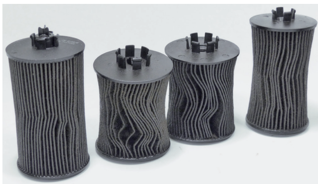
Figura 1: Elementos filtrantes de aceite colapsados
