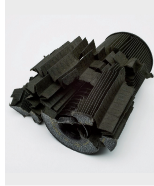
Resim 2: Tahrip olan yağ filtresi elemanı
