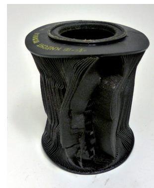
Zdjęcie 3. Wkład filtra oleju przegrzania zdeformowany/rozerwany wskutek
