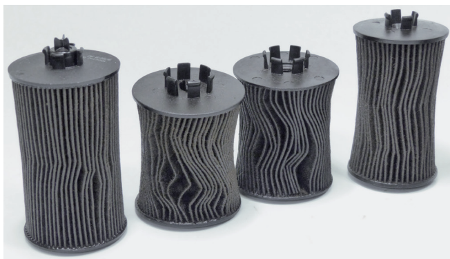
Figure 1 : Affaissement des cartouches de filtre à huile
