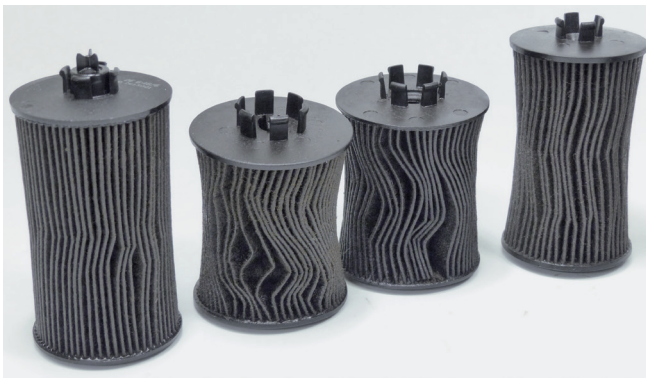
Εικόνα 1: Κατεστραμμένα στοιχεία φίλτρων λαδιού
