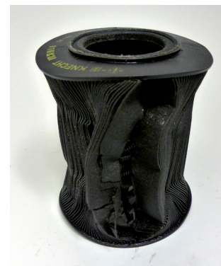
Figure 3 : Déformation/déchirement d'une cartouche de filtre à huile suite à la surchauffe
