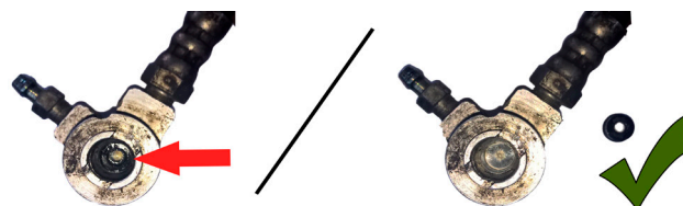
Bild 3: Alten Dichtring im Anschlußstück unbedingt entfernen
