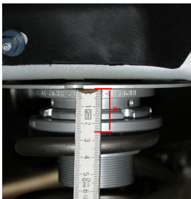
Abb. 4: Einstellmaß Hinterachse (Abb. ähnlich) Fig. 4: Adj. dimension rear axle (Fig. may vary)
