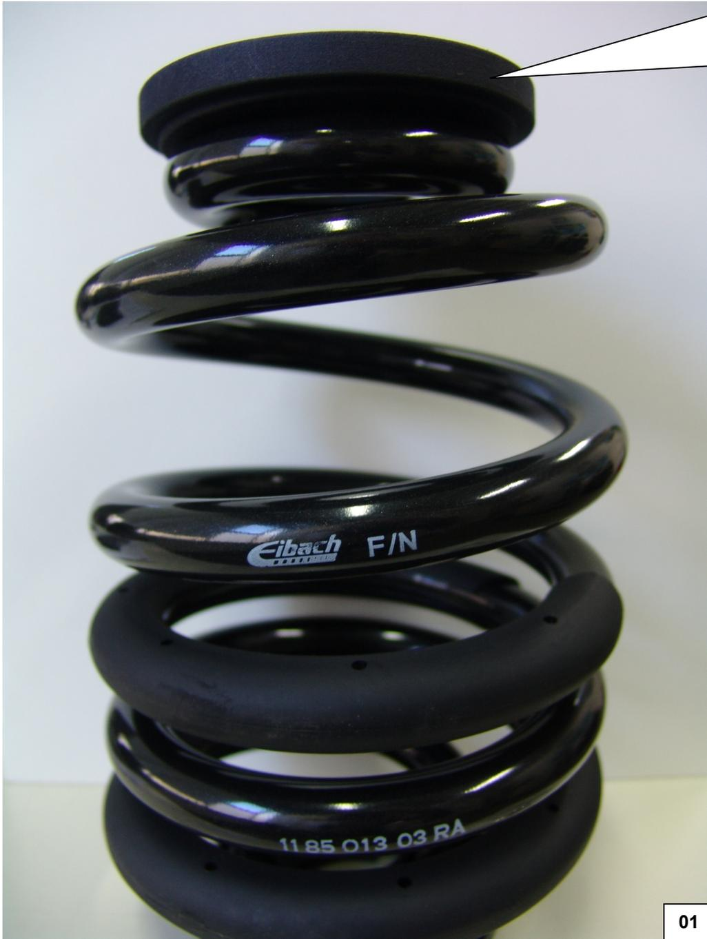
Der Federteller wird oben montiert u. ersetzt die serienmäßige Federunterlage.
