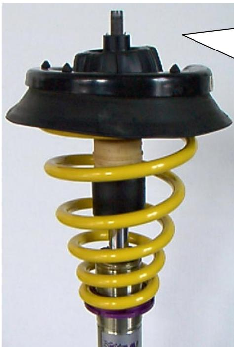
Original – Federteller und Stützlager auf die Feder aufsetzen und mit der serienmäßigen Schlitzmutter mittels geeignetem Werkzeug verschrauben. Dabei auf die richtige Positionierung der Feder im Federteller achten. Zur Befestigung des Federbeins im Fahrzeug verwenden Sie die mitgelieferte Stopnmutter. Anzugsdrehmoment beträgt 60Nm.
