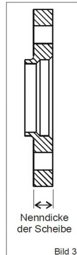
6. Bei ordnungsgemäßem, spielfreiem Sitz der Distanzringe und korrekt eingepressten Rändelbolzen werden die **Pro-Spacer** Distanzringe mit den Originalmuttern am Radträger montiert.
