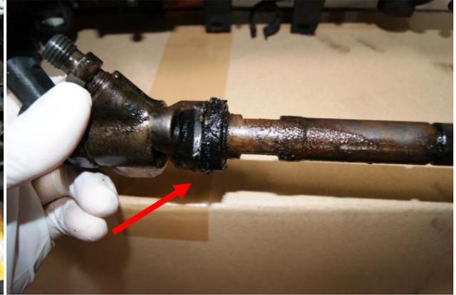
Bild 2: Halterung am Düsenstock undicht- neu abdichten
